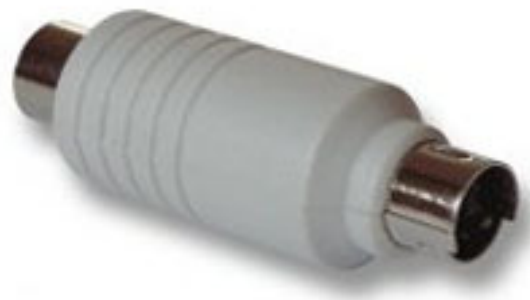
Een hardware-keylogger (PS/2)
